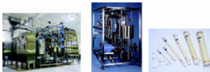
图 8. 中空纤维膜过滤生产系统和中空纤维滤柱
